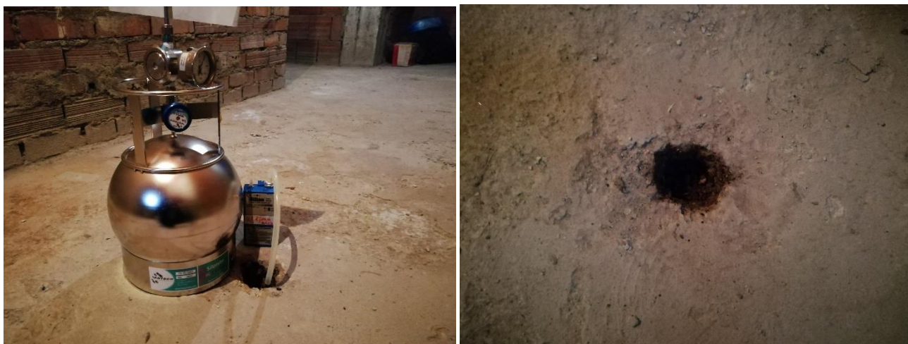
Foto apparato di campionamento e foro di inserzione sul pavimento
